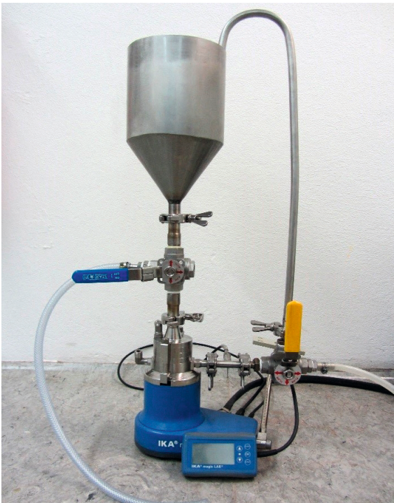
Abb. 5 // Aktiver Mischer IKA magicLAB mit Vorlagebehälter und Recycle-Rohrleitung (Bild: J. Walther).
